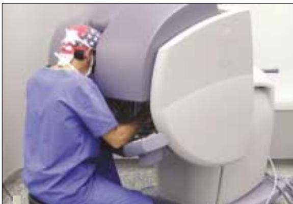
**FIGURE 2 : Console chirurgicale permettant de travailler de façon virtuelle, les mains du chirurgien contrôlant à distance les instruments intrathoraciques.**
